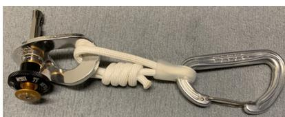
Plutôt que d'utiliser un anneau en cordelette dyneema, on peut préférer un anneau de sangle Petzl : « St'anneau » de 24 cm en double. Cette solution évite le problème de glissement du pêcheur double sur la dyneema neuve (la notice Béal dit faire pêcheur triple), travaille très bien sur le bord étroit de la plaquette, sur résistant en résistance pure (44 kN ! ) et au frottement (largeur) enfin, c'est démontable-récupérable ... poids : 10 g, prix Expé : 4,95 €
