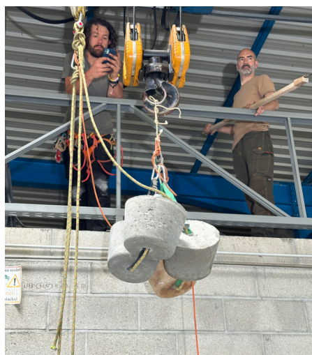
Même installation que le test précédent mais pour le test de facteur de chute 0,4.
