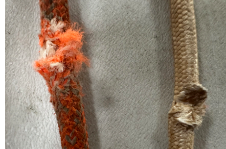
Constat visuel d'une abrasion équivalente pour de la corde Slick-Line Std comparée à de la cordelette Pur Dyneema®.
