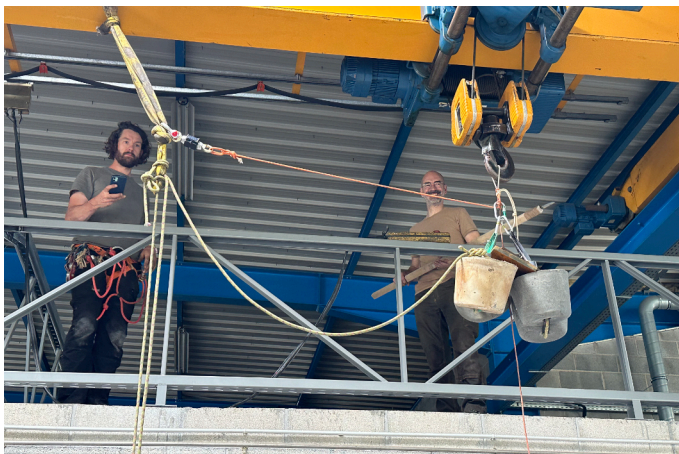
Antoine Heil surveille le dynamomètre. Pierre Rimbart s'apprête à couper la cordelette qui retient la gueuse de 80 kilos.
