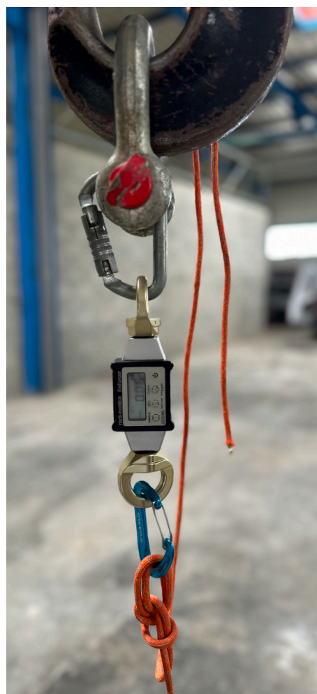
Le montage du dynamomètre pour les tests de progression sur agrès permet de constater le poids d'Antoine équipé au repos : 90 daN.
